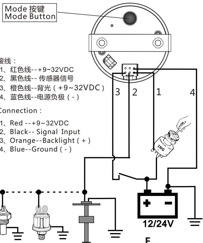
参考E图连接电线，如果是电压表和小时计，则没有黑色电线
