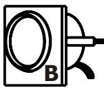
如B图，将仪表放入开好孔的仪表面板中
