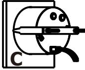
如C图，用M4螺母和C型固定扣将仪表锁紧在仪表板上
